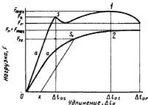
1—материал имеет предел текучести; 2—материал не имеет предела текучести; а—участок прямолинейного направления кривой в начале кривой «нагрузка—удлинение»;  $S$ —предел текучести;  $x$ —отрезок на оси удлинения для определения условного предела текучести;  $S_x$ —условный предел текучести.
